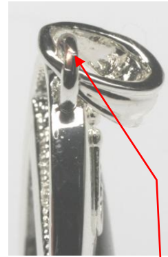
7.att. Zem apsudrabošanas redzams sārtais vara slānis
