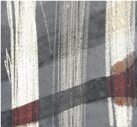
10.att. Pa kreisi Ag920 ar svinu, pa vidu Ag925 ar vidēji biezu niķeļa pārklājumu, pa labi 925 proves adata ar varu. Ar \text{AgNO}_3 prove ir paaugstināta sakausējumam ar svinu, bet ar \text{K}_2\text{Cr}_2\text{O}_7 tā ir līdzīga kā 925 adatai. Izstrādājums ar niķeļa pārklājumu ar abiem reaģentiem reaģē pavisam savādāk.
