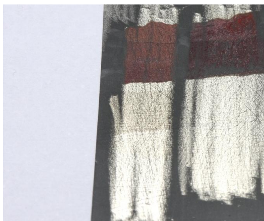
8.att. Pa kreisi Ag925 probes adata ar varu, pa labi 914 proves sudrabs ar 1,8% zeltu ligatūrā. Ar AgNO_3 prove ir paaugstināta, bet ar K_2Cr_2O_7 tā ir pazemināta
