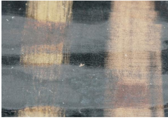
18.att. Pa kreisi 333 proves zelta sakausējums, pa labi 585 proves zelta sakausējums. Augšā reakcija ar 375 proves noteikšanas šķīdumu, bet apakšā ar 585 proves noteikšanas šķīdumu.
