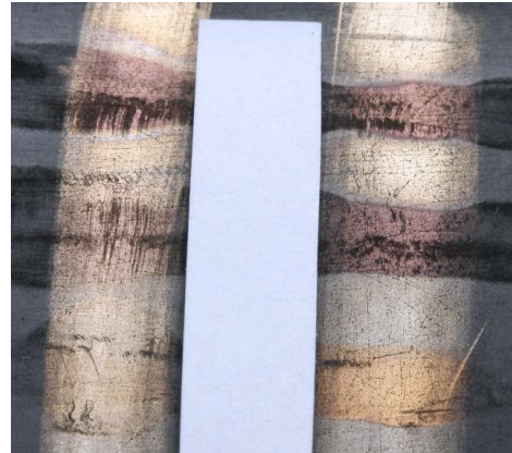
19.att. Pa kreisi Alloy 13, pa labi Alloy 14 sakausējums. Augšā reakcija ar 585 proves noteikšanas šķīdumu 10 sekundes, pa vidu reakcija ar 585 proves noteikšanas šķīdumu 5 sekundes, bet apakšā ar tetrahlorzeltskābes šķīdumu.
