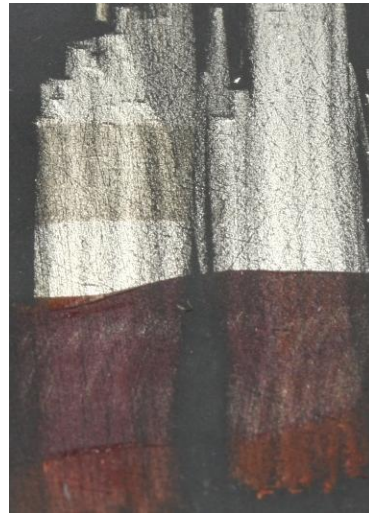
11.att Pa kreisi Ag925 proves adata ar varu, pa labi 999 proves sudrabs. Ar \text{AgNO}_3 reakcija nenotiek.
