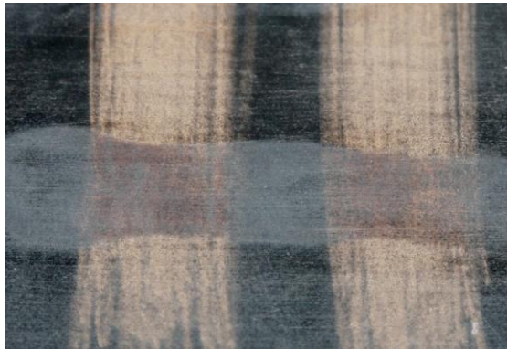
22.att. Pa kreisi 578 proves zelta sakausējums (PSRS laiku 583), pa labi 585 proves zelta sakausējums. Reakcija ar 585 proves noteikšanas šķīdumu.
