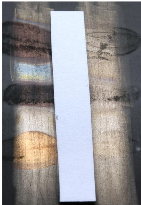
21.att. Pa kreisi Alloy 14, pa labi Alloy 20 sakausējums. Augšā reakcija ar 585 proves noteikšanas šķīdumu, pa vidu reakcija ar 750 proves noteikšanas šķīdumu, bet apakšā ar tetrahlor-zeltskābes šķīdumu.
